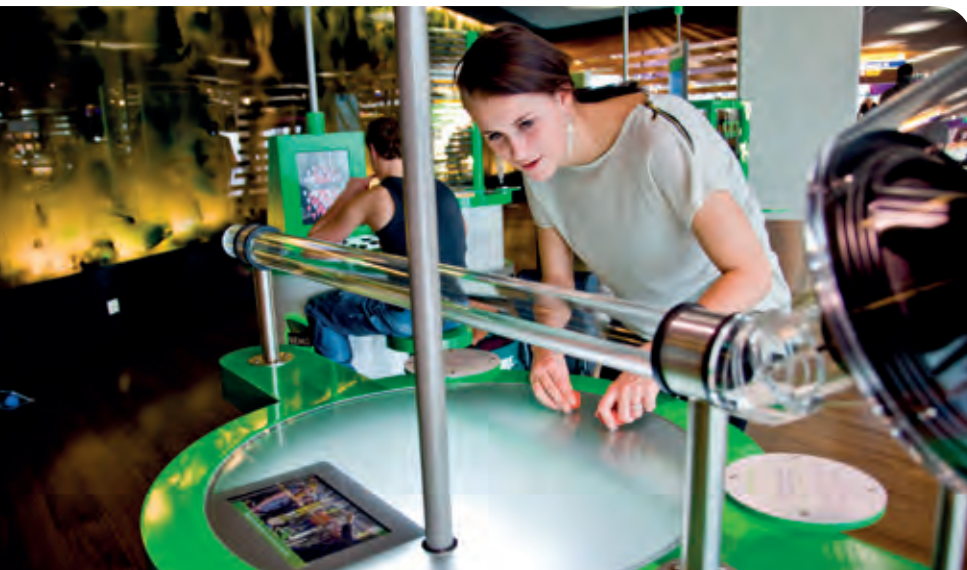
NEMO op Schiphol. In de buis van Kundt brengt geluid de lucht boven de vloeistof in beweging, waardoor de vloeistof zelf ook gaat bewegen. Alleen bij bepaalde toonhoogten ontstaan golven in de vloeistof.
