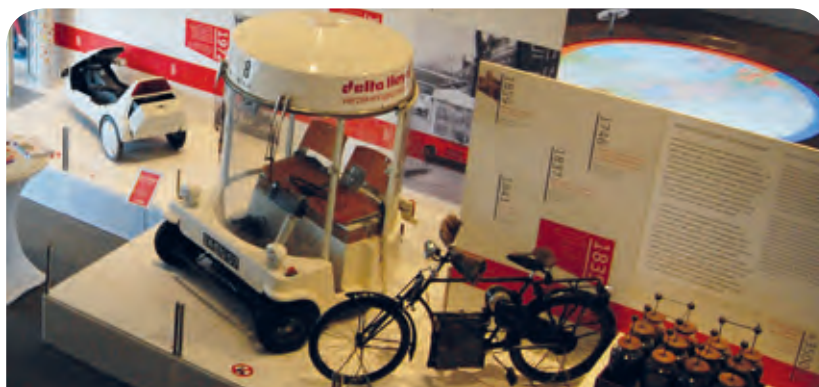
Elektrisch vervoer is niet nieuw. De Juncker fiets (1933) had een bereik van 40 km in 2,5 uur. Opladen duurde een hele dag. En de Witkar met elektromotor (1974) reed 30 km per uur, opladen duurde 7 minuten.
